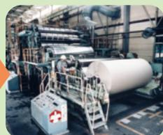
紙すき、脱水、乾燥工程後、ロール状に巻き上げます。
